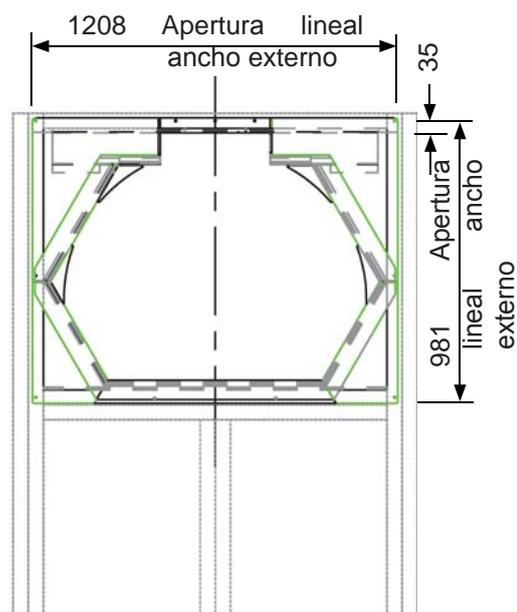
Las dimensiones de ancho y fondo de 1208mm x 981mm deben estar disponibles arriba y abajo, tomando en cuenta el ancho y la resistencia de las paredes, para asegurar que el ascensor trabaje con holgura.
